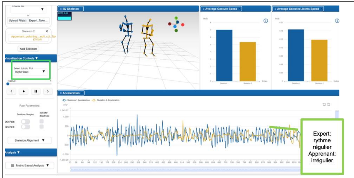
Fig. 4 - La comparaison de l'accélération de la main droite entre experte (bleu) et apprenant (jaune)
